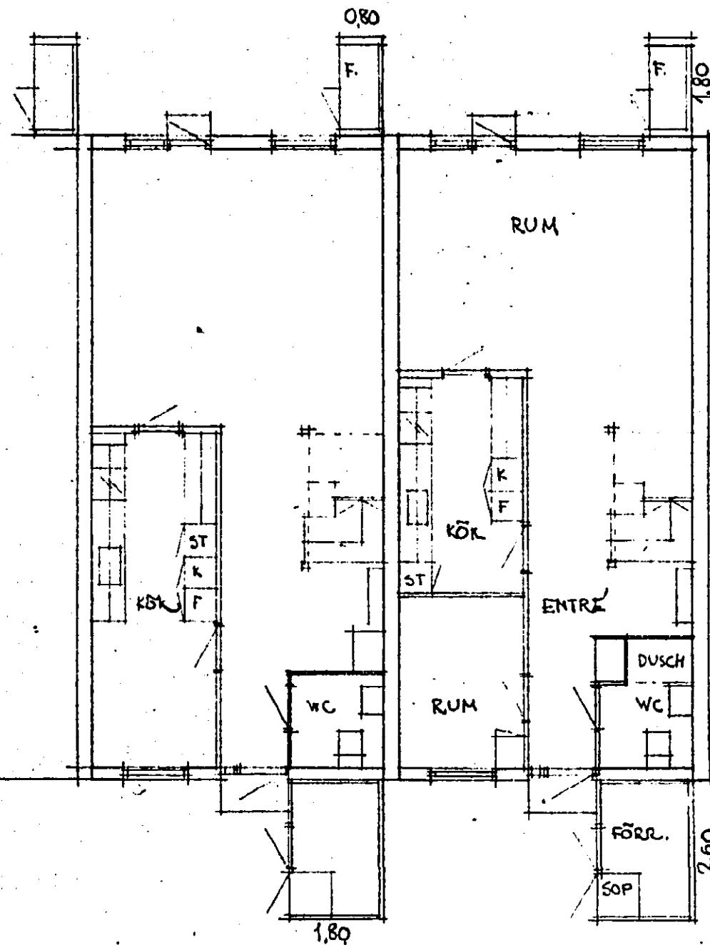
Sopskåp skall vara av renhållningsverket godkänd typ utrustat med upphängningsdelen på dörr för verkets säckhållare. Dörrens underkant ca 10 cm över angränsande markyta.
